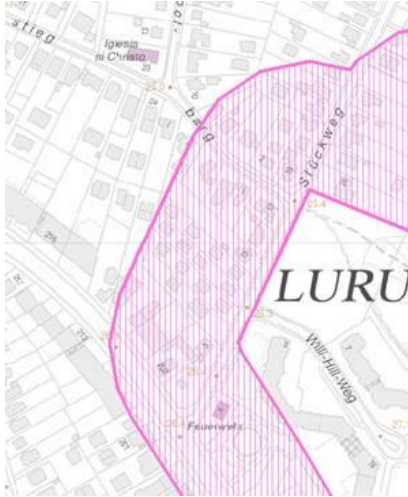
Abb. 1: Gaswanderungszone der Altlast 5640-001/00, Böverstland im Bereich des Bebauungsplangebietes Lurup 6
